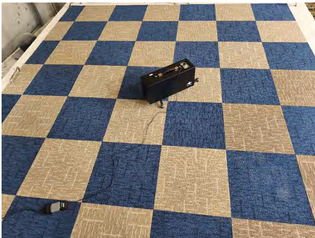
Foto A.6: Ensaio com a máquina de impacto.
