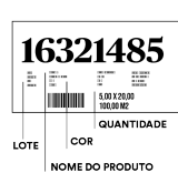
Inspeção - nome, cor, lote e quantidade
